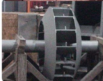
En la foto se ve el rotor de un ventilador de tiro inducido, montado del lado sucio de salida de un alto horno. Rotor de 82" de diámetro con revestimientos de paleta de carburo de cromo.
